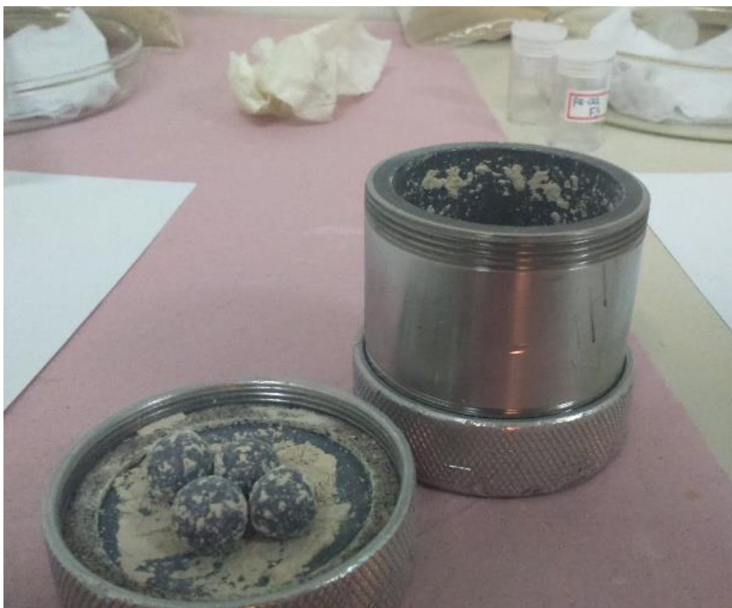
Figura 18. Cadinho e bolas de carbeto de tungstênio utilizados na pulverização do material particulado.
