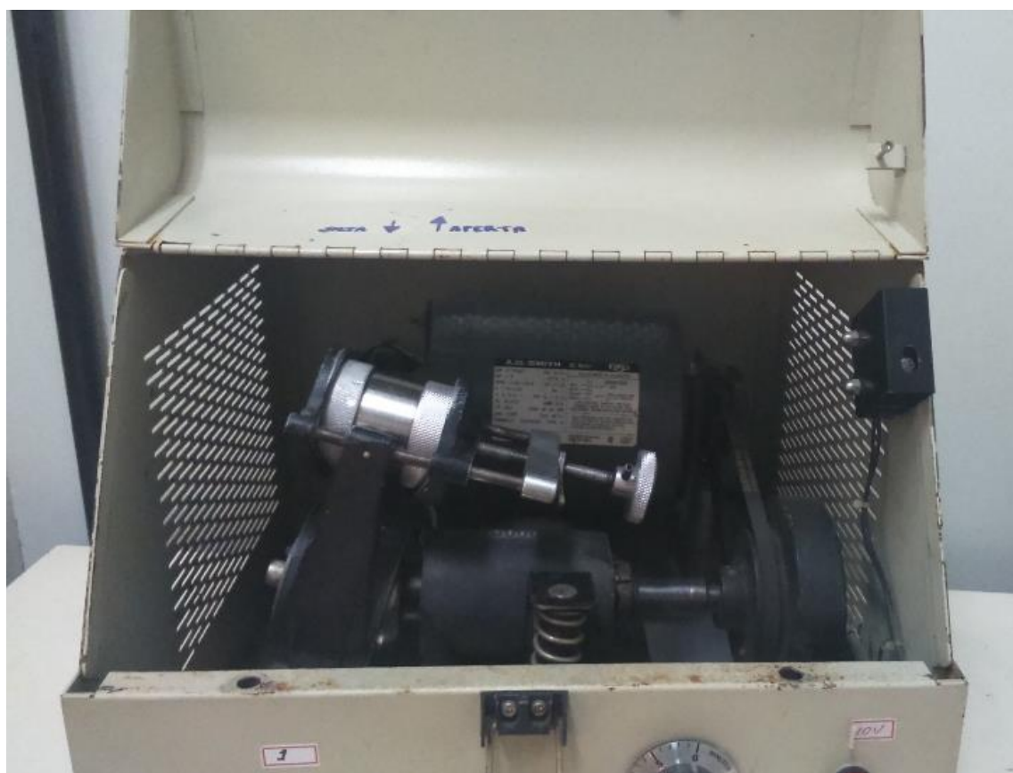
Figura 17. Moinho SPEX com cadinho acoplado. O motor movimenta o braço do moinho produzindo vibração do cadinho.
