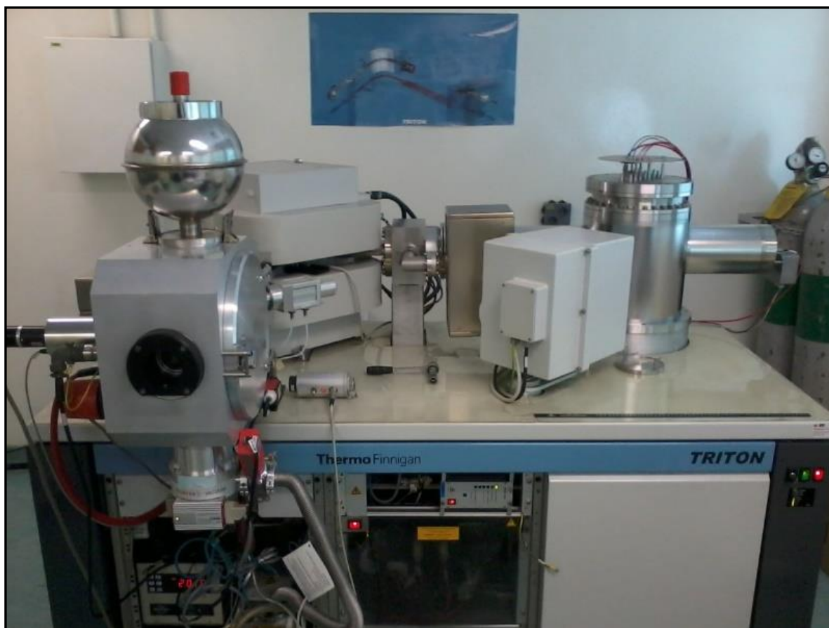
Figura 22. Espectrômetro de massa portermo-ionização (TIMS) multicoletor, modelo TRITON da Thermo Scientific.
