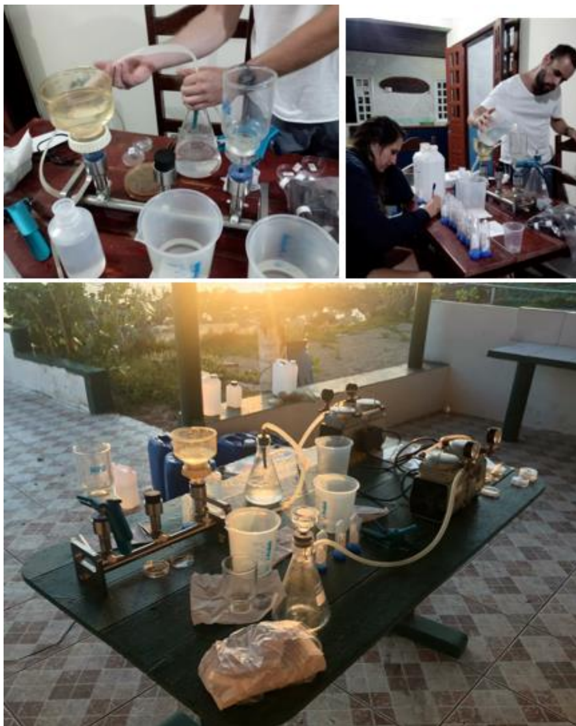
Figura 15. Sistema de filtragem com Manifold.
