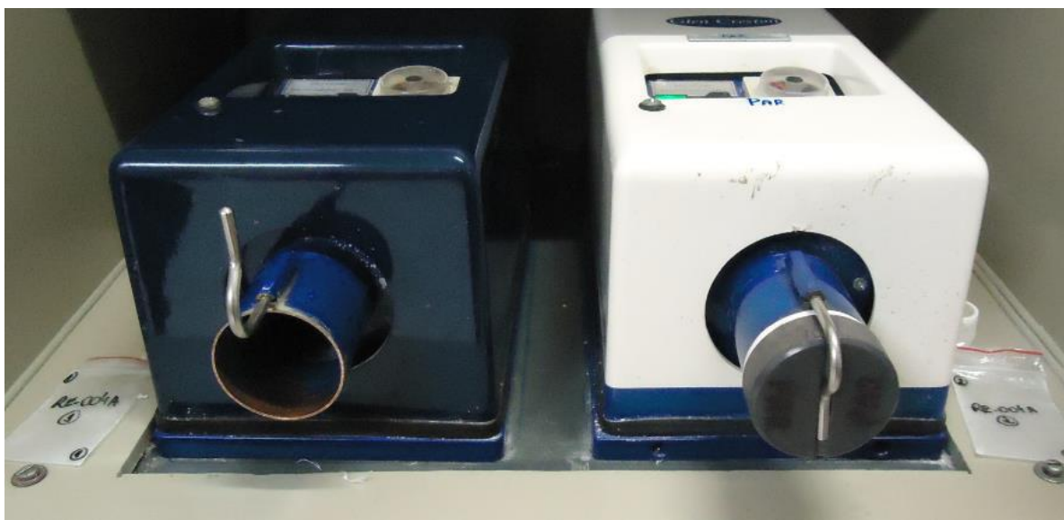
Figura 23. Moinho vibratório micronizador modelo McCrone.
