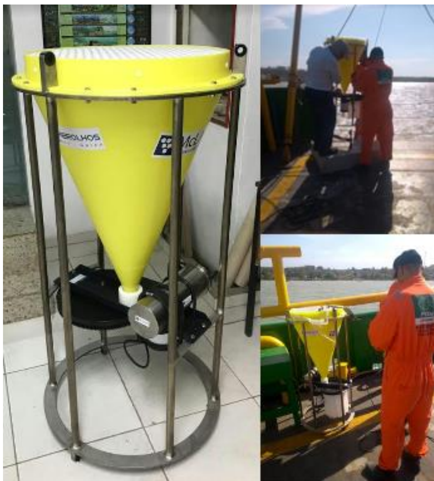
Figura 8: Sistema automático de coleta de sedimento (McLane) e sua instalação no Parque Nacional dos Abrolhos.
