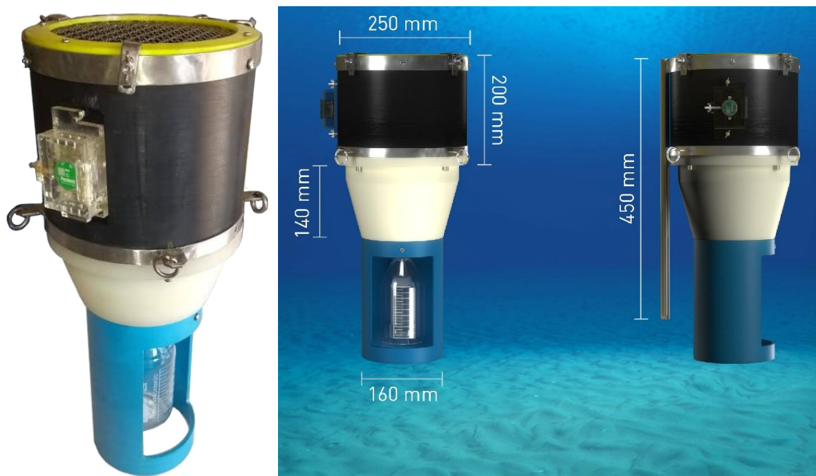
Figura 7: Detalhes de partes da armadilha de sedimento (Modelo Abrolhos 3) testada em Abrolhos.
