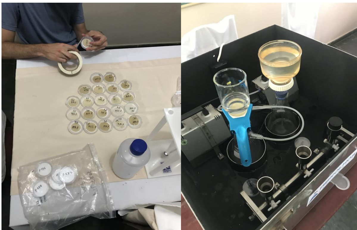
Figura 16. Filtros após amostragem e sistema de filtragem.
